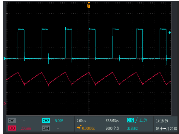
SW脚与电感电流工作波形
