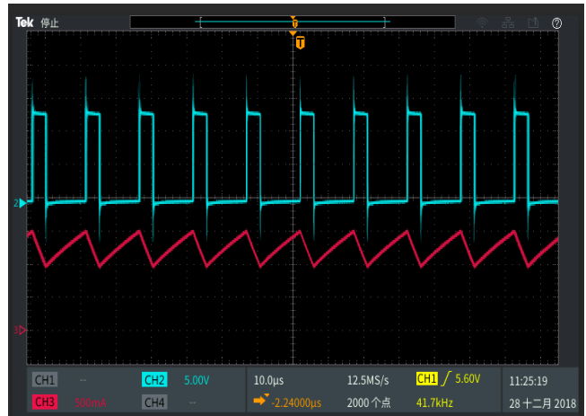
SW 脚与电感电流工作波形
