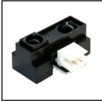
ORD1M13は、赤外LEDとPSDを組み合わせた三角測量方式の赤外線測距センサです。一定の距離で出力が切り替わるデジタル出力タイプで、人や物体の有無を検知する用途に最適です。
