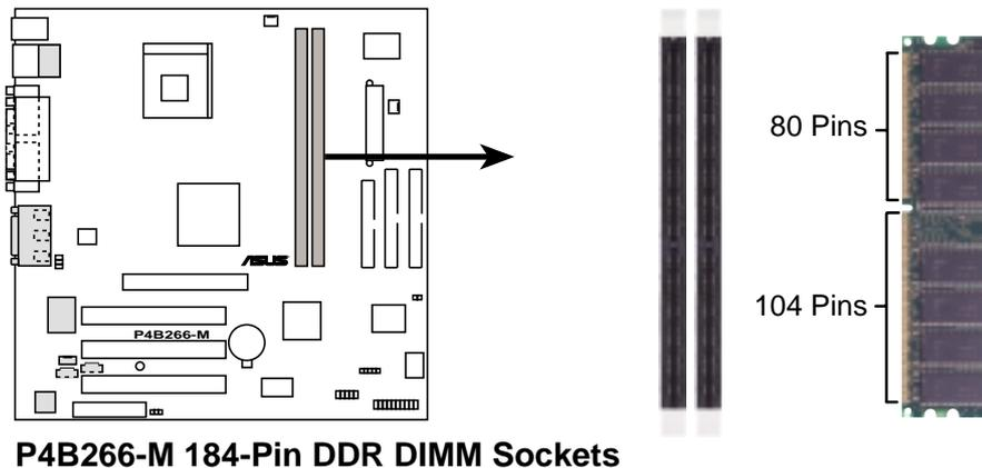
**P4B266-M 184-Pin DDR DIMM Sockets**
