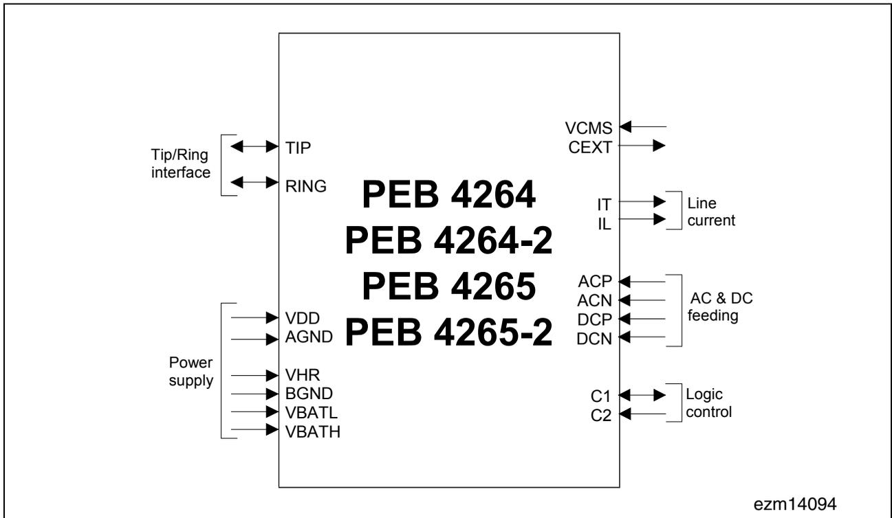
**Figure 3** Logic Symbol: SLIC-S/SLIC-S2 (V1.1, V1.2), SLIC-E/SLIC-E2 (V1.1)
