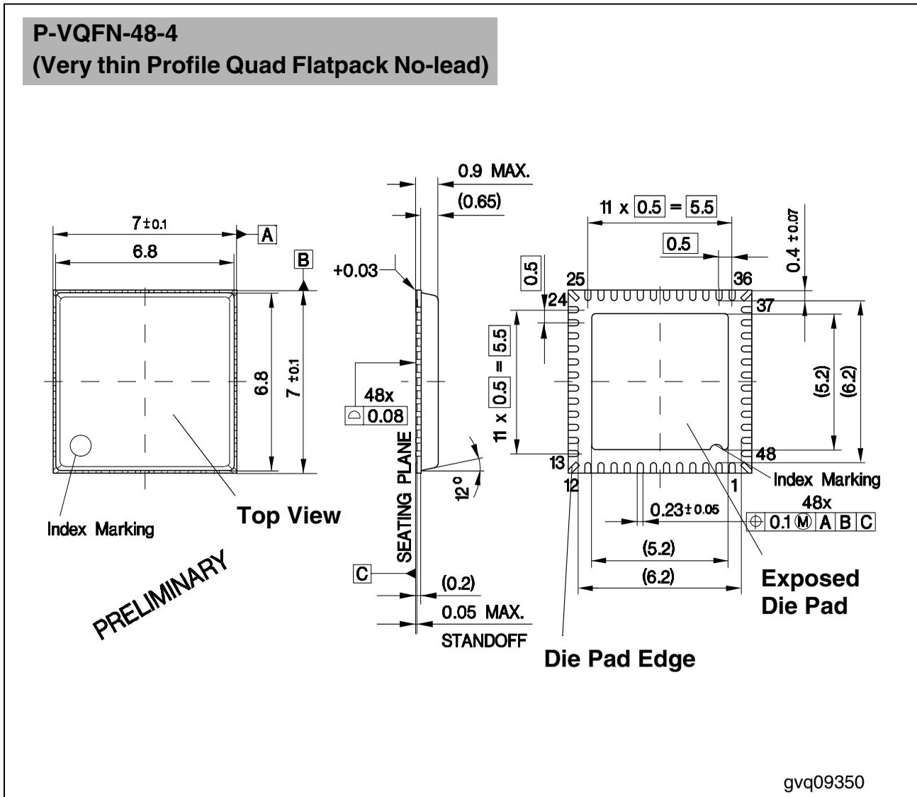
Figure 98 SLIC-S/-S2, SLIC-E/-E2, SLIC-P (PEB426x)
