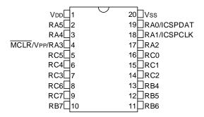
Figure 2-4. 20-Pin QFN
