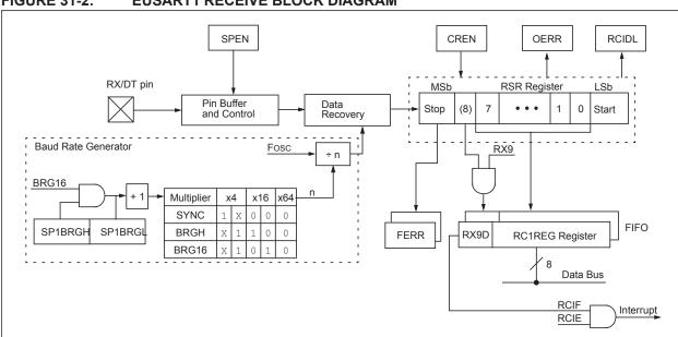
FIGURE 31-2: EUSART1 RECEIVE BLOCK DIAGRAM
