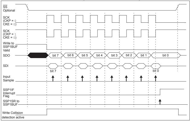
**FIGURE 30-10:** SPI MODE WAVEFORM (SLAVE MODE WITH CKE = 1)
