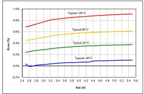
**FIGURE 36-95:** FVR Voltage Error (2x), PIC16F18324/18344 Only
