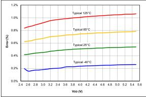
**FIGURE 36-93:** FVR Voltage Error (1x), PIC16F18324/18344 Only
