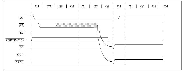
FIGURE 10-17: PARALLEL SLAVE PORT READ WAVEFORMS
