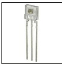
PIC4103SLは、フォトダイオードと信号処理回路(増幅、シュミット、定電圧)を1チップに集積したデジタル出力タイプの受光素子です。
