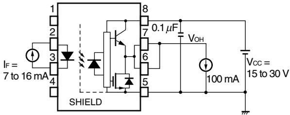
Fig. 4 V<sub>OL</sub> Test Circuit
