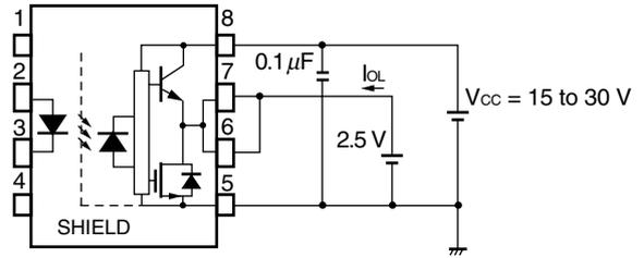
Fig. 3 V<sub>OH</sub> Test Circuit
