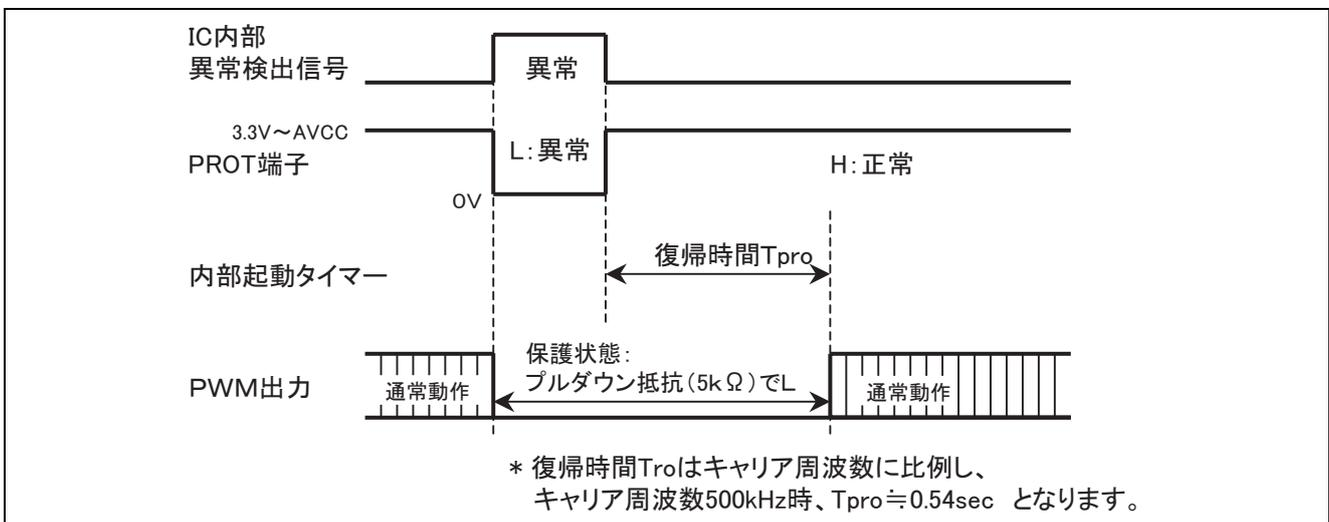
$$\text{起動時間} : T_{pro} \approx 270/fc[\text{kHz}]$$
