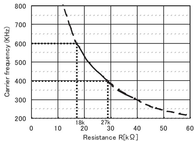
PWM 信号生成用の基準クロック(キャリア)は、34 ピン : ROSC の外部抵抗値によって 400kHz~600kHz の範囲で設定できます。
