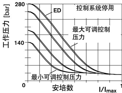
静态电流压力特性的滞后 < 3 bar
