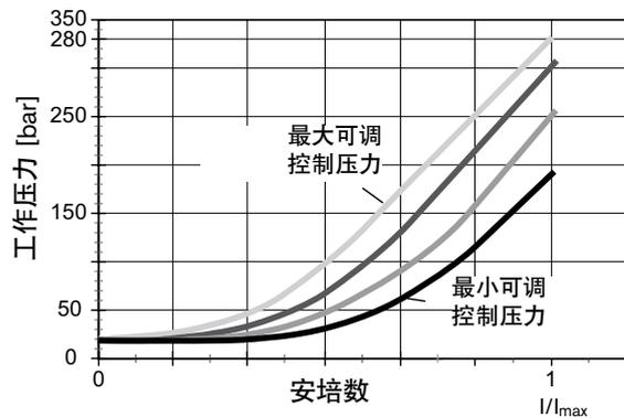
静态电流压力特性的滞后 < 3 bar
