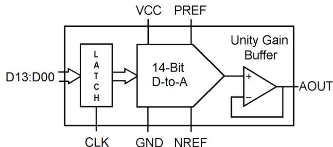
**FIGURE 1: BLOCK DIAGRAM**
