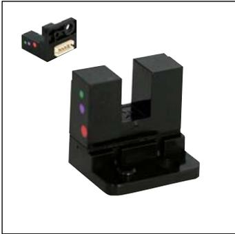
SG2A01-Aは、高出力赤外発光ダイオードと高感度フォトトランジスタを組み合わせた汎用透過型インタラプタです。耐油性・耐溶剤性に優れた防塵二重構造です。
