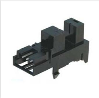
SG2A241は、高出力赤外発光ダイオードと高感度フォトトランジスタを組合わせた透過型フォトインタラプタです。高精度位置検出に適した汎用インタラプタです。
