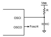
(4) External input clock: 30KHz - 4MHz.
