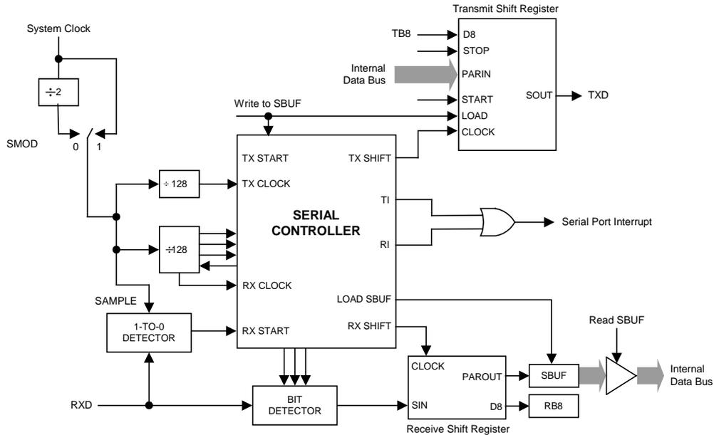
任何将SBUF作为目标寄存器的写操作都会启动发送，同时也将TB8载入到发送移位寄存器的第9位中。实际上发送是从16分频计数器中的下一次跳变之后的系统时钟开始的，因此位时间与16分频计数器是同步的，与对SBUF的写操作不同步。起始位首先在TXD引脚上移出，然后是9位数据。在发送转换寄存器中的所有9位数据都发送完后，停止位在TXD引脚上移出，在停止位开始发送时TI标志置位。
