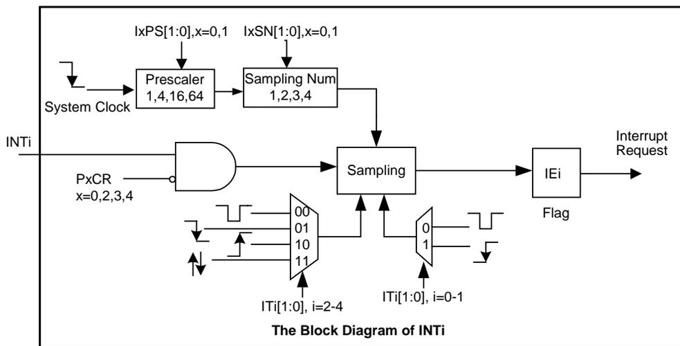
**注意：**外部中断0-1的中断标志位在执行中断服务程序时被自动硬件清0，但外部中断4标志位IF40-46必须要软件清0。
