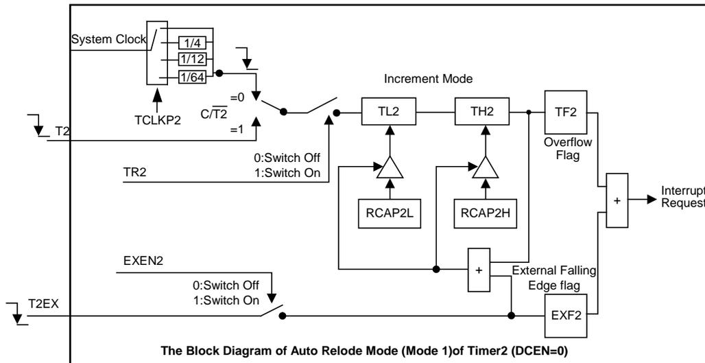
设置DCEN位允许定时器2递增计数或递减计数。当DCEN = 1时，T2EX引脚控制计数的方向，而EXEN2控制无效。
