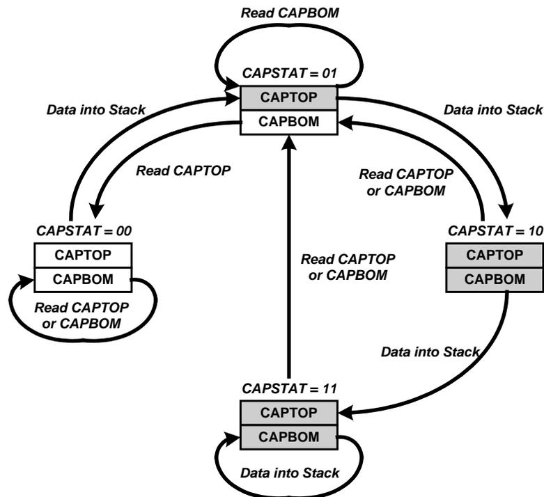
图8-8-1 输入捕捉过程状态机转换与存储栈操作图
