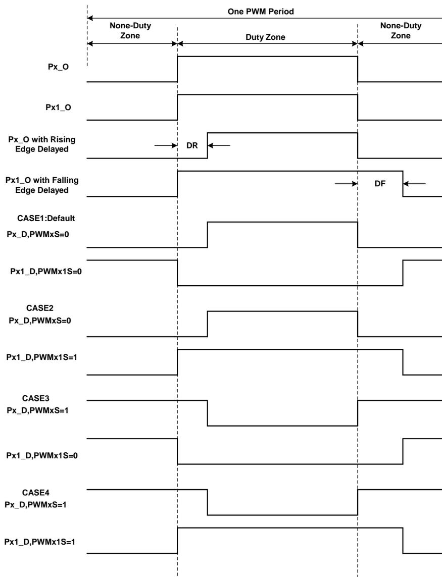
图8-1-13 不同极性设置下的死区波形
