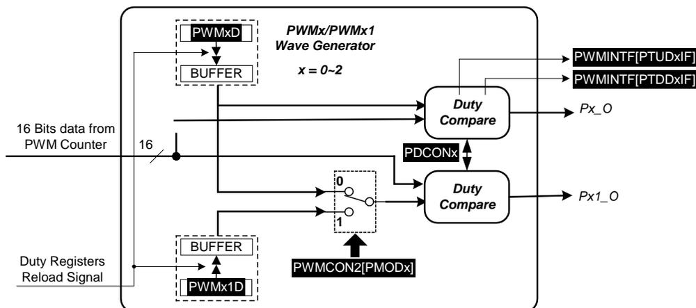
图8-1-6 波形发生器逻辑简图
