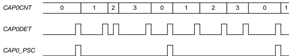
图8-8-2 预分频设置的工作波形
