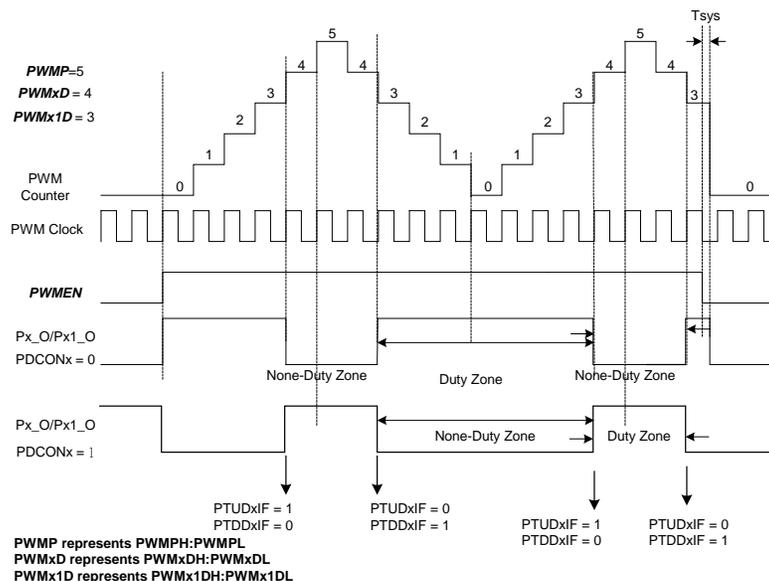
图8-1-9B 中心对齐计数、互补输出模式下的PWM原始波形（非对称波形）
