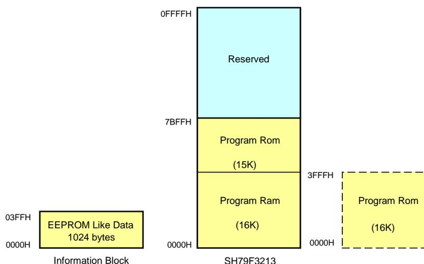
SH79F3213为存储程序代码内置31K可编程Flash程序存储区（Program Memory Block），支持在线编程（ICP）模式和扇区自编程（SSP）模式对Flash存储器操作。每个扇区512字节。
