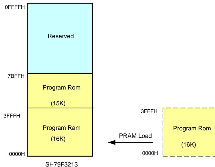
当程序空间的低16K地址（0000H - 3FFFFH）选择为Program RAM区域时（默认是Flash），数据存取速度相比其他Program Rom（Flash，4000H - 7BFFFH）要快得多，因此RAM中程序可以以更高速度执行，用户可以将对执行速度要求高的代码通过连接器定位在此范围内（0000H - 3FFFFH），在PRAM加载完成后，通过设置PLL将系统频率倍频到更高速度（最大84MHz）来执行此部分代码；而在其他区域，由于此时系统时钟超出Flash的存储速度限制，因此CPU会自动以降频的方式FLASH执行Flash中代码（无需用户参与）
