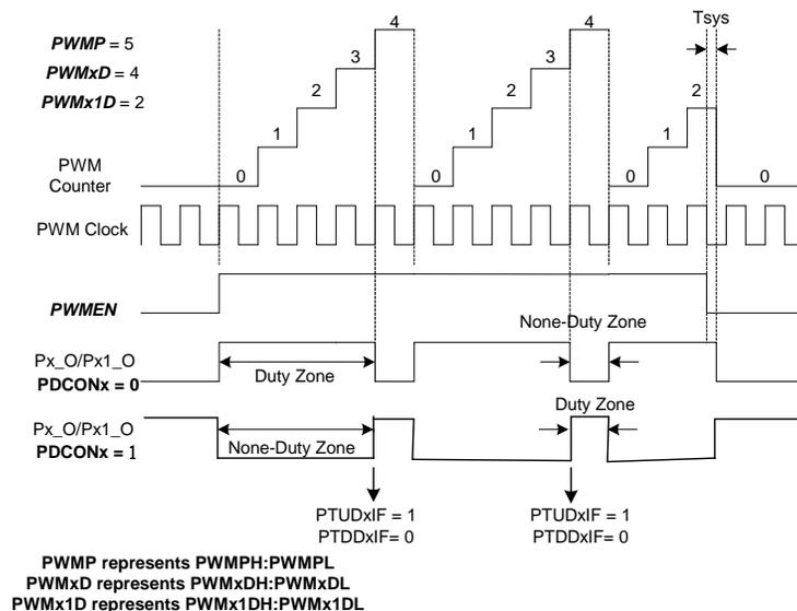
图8-1-7 边沿对齐计数、互补输出模式下的PWM原始波形
