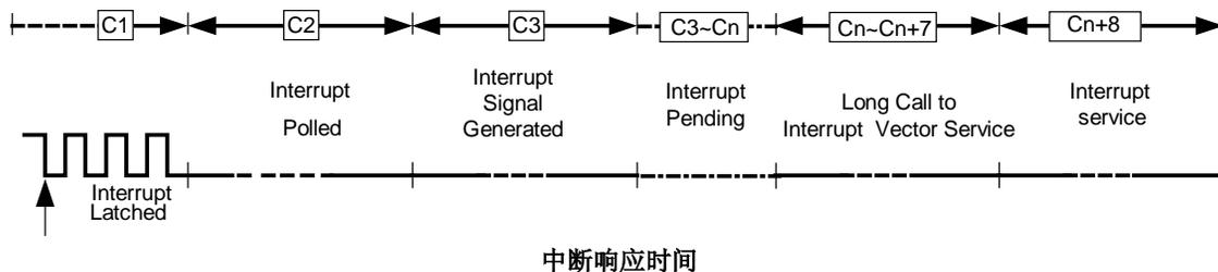
由硬件产生的LCALL把程序计数器中的内容压入堆栈（但不保存PSW），然后将相应中断源的向量地址（参照中断向量表）存入程序计数器。
