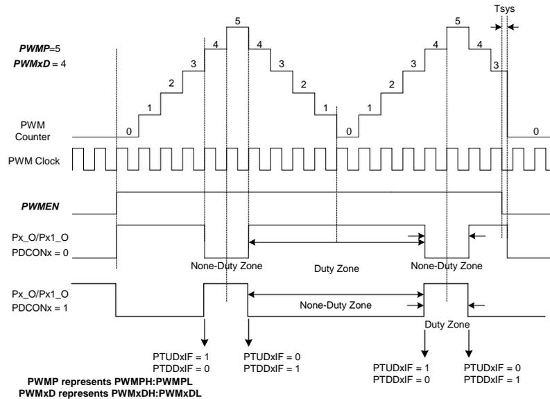
图8-1-9A 中心对齐计数、互补输出模式下的PWM原始波形（对称波形）
