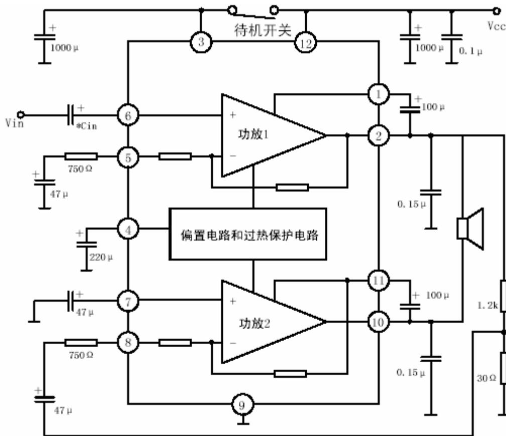
注：此电路在应用中可以不用耦合电容（C<sub>IN</sub>），如果音量电位器产生的噪声大于此电路的输入失调电压，则需要使用耦合电容（C<sub>IN</sub>）。
