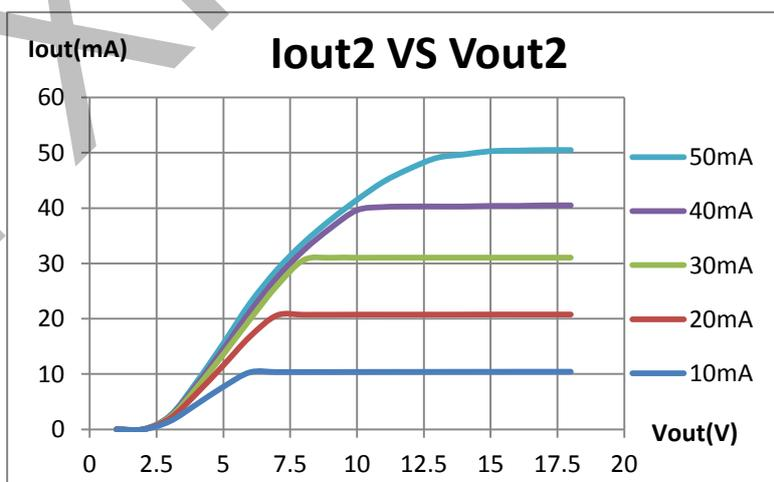
图 2 SM2196E Iout2 恒流曲线图
