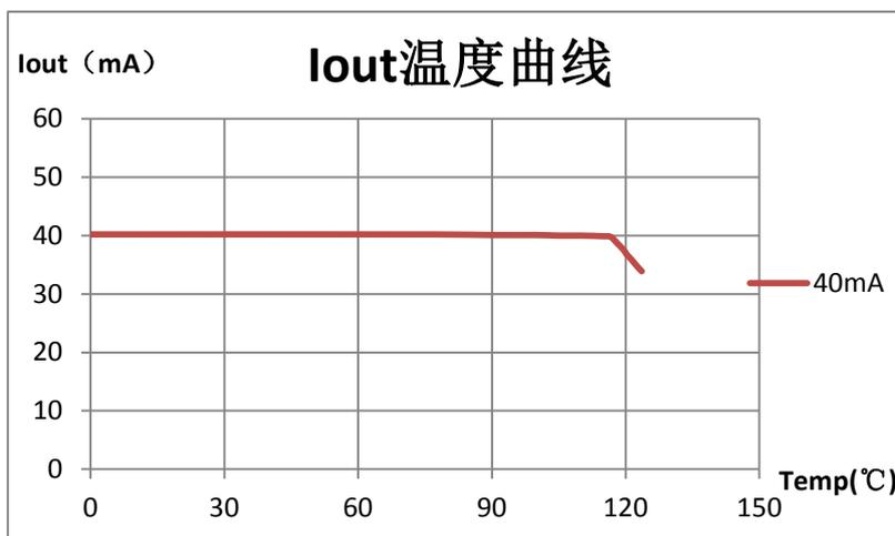
图 3 SM2196E 输出电流温度特性（注 7）
