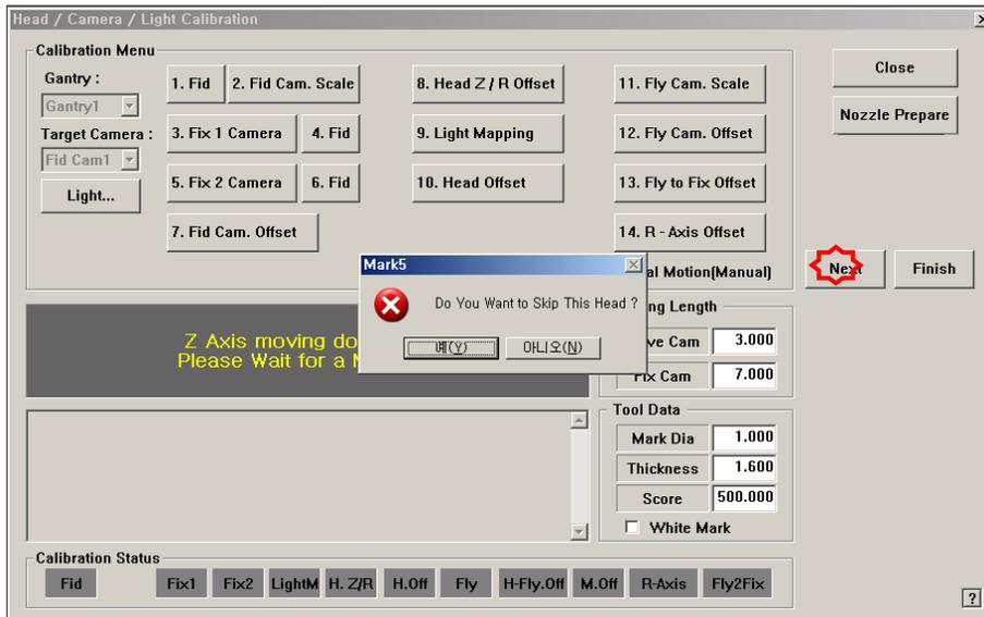
6. 显示“移动到中心位置[固定1]摄像。移动，点击[下一步]”。为了Head Assembly移动到 Fix1 Camera的中心位置，请点击<下个> 按钮。
