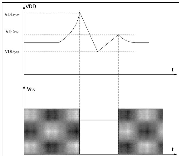
当芯片 VDD 的电压超过 VDD<sub>OVP</sub> 时，会触发内部复位信号，导致系统重新启动。
