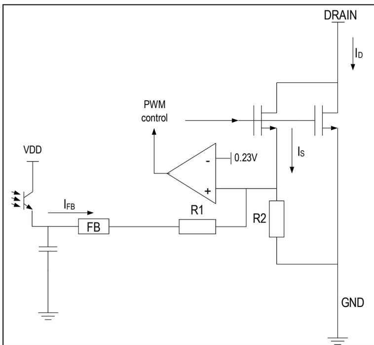
通过高压 MOS 的电流  $I_D$  分成两个部分，其中一部分为  $I_S$ ，这部分电流为芯片采样电流。 $I_S$  与  $I_D$  成比例关系：
