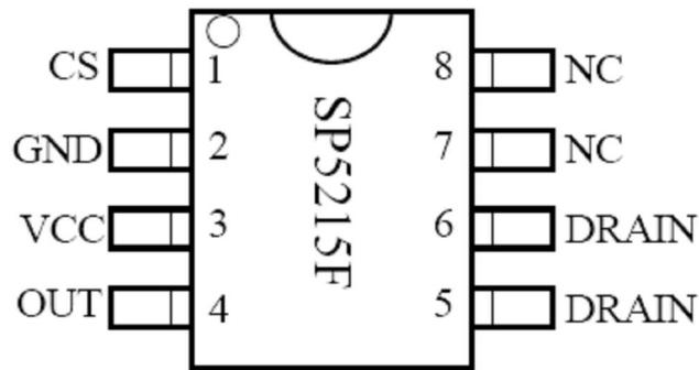
图 2.管脚结构
