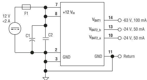
RECOMMEND SOLID GROUND PLANE ON COMPONENT SIDE OF MOTHER BOARD UNDER SPT5204QL.
