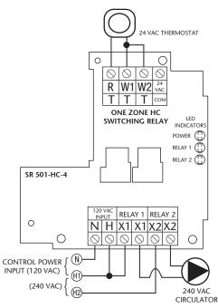
ONE ZONE, NO BOILER ENABLE (CONTROL & CIRCULATOR SAME POWER SOURCE)
