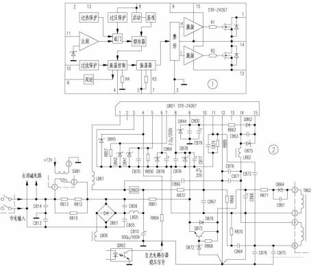
新型大屏幕彩电电源厚膜电路STR-Z4267
