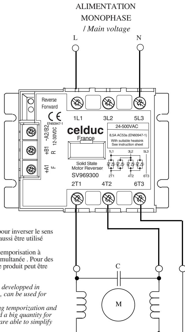
**Note :** Le relais SV969300 développé initialement pour inverser le sens de rotation des moteurs asynchrones triphasés peut aussi être utilisé pour l'inversion de moteurs monophasés .
