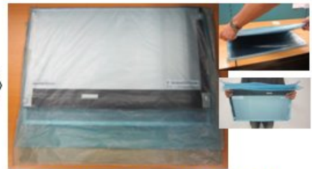
2 nd Panel可視區朝下 & T-CON朝向袋口, 放入靜電袋,使2pcs Panel的可視區面對面
