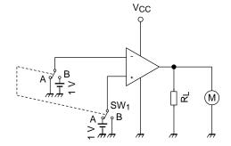
$V_{OH}$ : SW<sub>1</sub> IS SIDE A  $V_{OL}$ : SW<sub>1</sub> IS SIDE B
