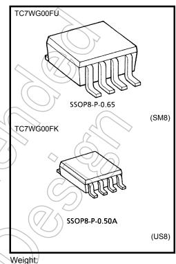
SSOP8-P-0.65 SSOP8-P-0.50A : 0.02 g (typ.) : 0.01 g (typ.)
