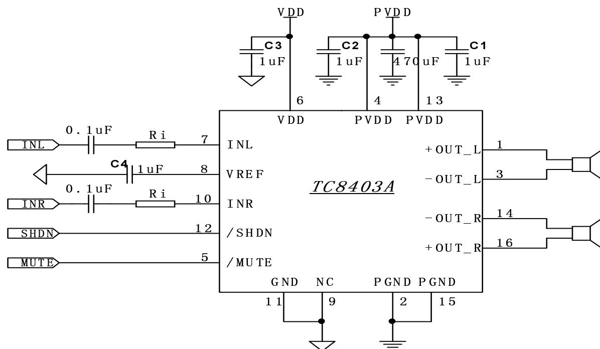
注：图中 C1、C2、C3、C4 在制作 PCB 板时，请尽量靠近 IC。
