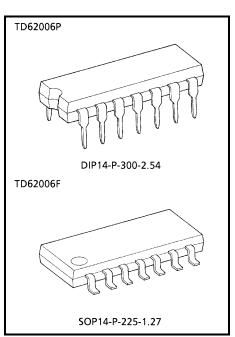
Weight DIP14-P-300-2.54: 1.11 g (typ.) SOP14-P-225-1.27: 0.16 g (typ.)
