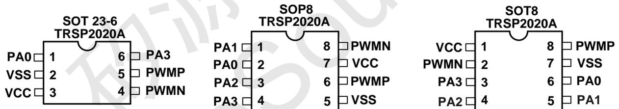
Figure 1. SOT23-6, SOP8 & SOT8 Package
