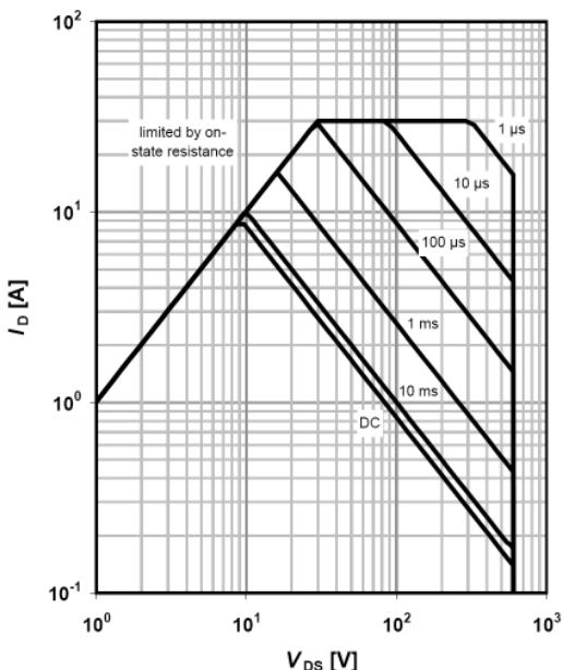
$I_D=f(V_{DS})$ ;  $T_C=25\text{ }^{\circ}\text{C}$ ;  $V_{GS} > 7\text{V}$ ;
