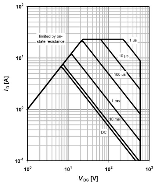
$I_D=f(V_{DS})$ ;  $T_C=80\text{ }^{\circ}\text{C}$ ;  $V_{GS} > 7\text{V}$ ;
