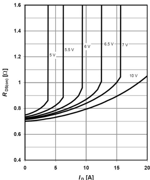
$R_{DS(on)}=f(I_D)$ ;  $T_j=125\text{ }^\circ\text{C}$  ;
