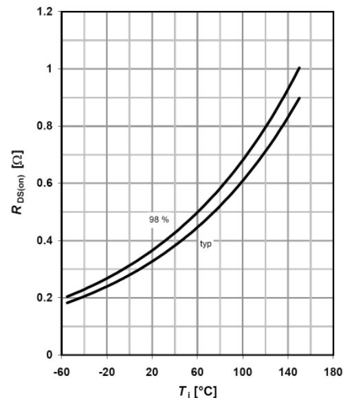
$R_{DS(on)}=f(T_j)$ ;  $I_D=3.8\text{ A}$ ;  $V_{GS}=10\text{ V}$
