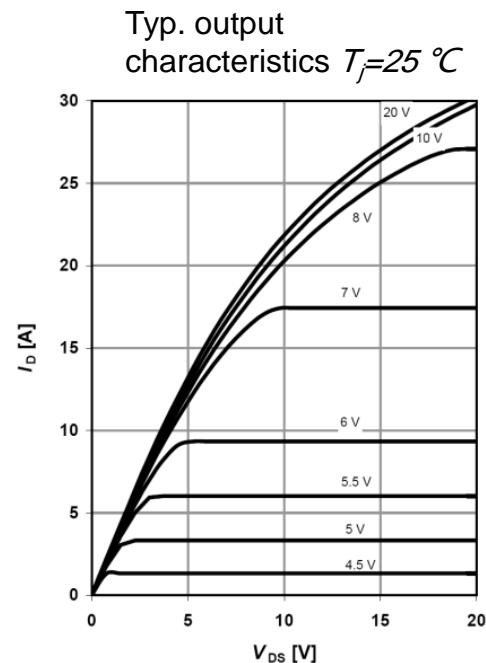
$I_D=f(V_{DS})$ ;  $T_j=25\text{ }^\circ\text{C}$  ; parameter:  $V_{GS}$
