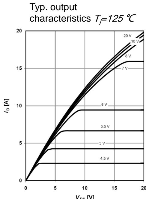
$I_D=f(V_{DS})$ ;  $T_j=125\text{ }^\circ\text{C}$  ; parameter:  $V_{GS}$
