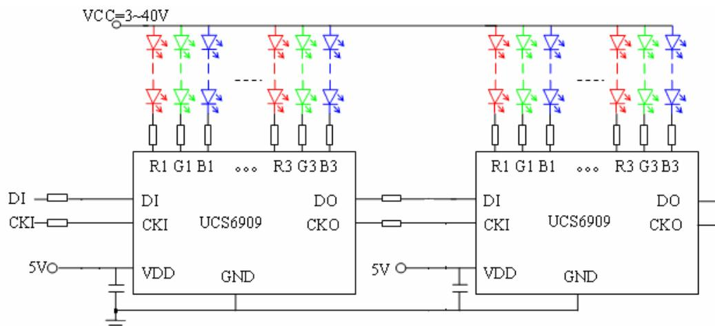
应用说明: 1.VCC 电压可根据应用中串联 LED 的个数适当调整, 最大不得超过 40V。
