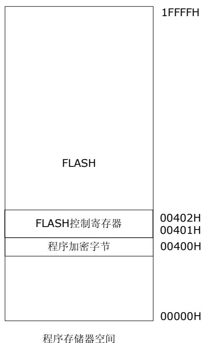
图 3-3 程序存储空间分配图
