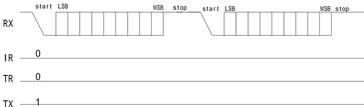
图 10.2.1 UART 主接口写操作时序
