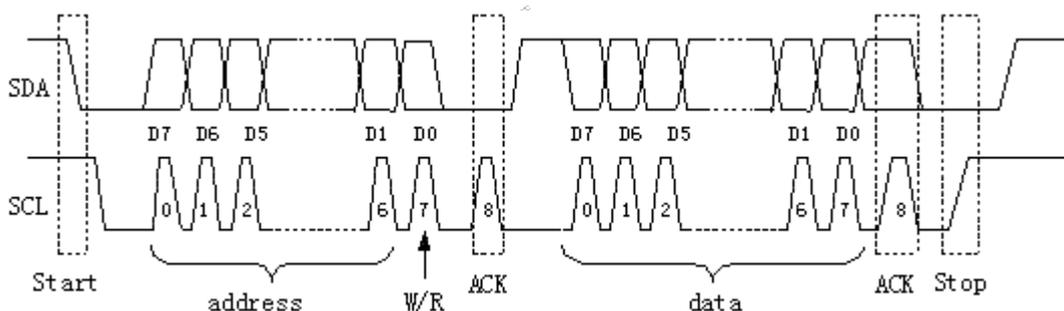
图 12.1.3 IIC 传输协议和格式
