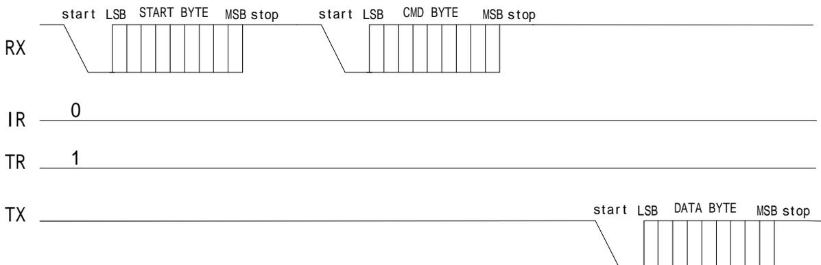
图 10.4.1 UART 主接口转义模式读操作时序
