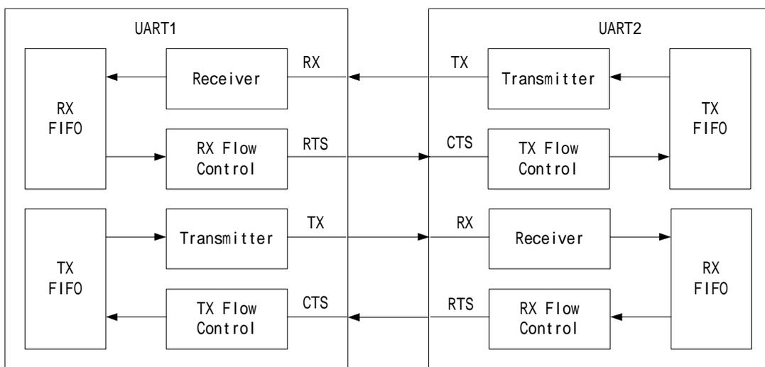
图 13.3.3.1 硬件流量控制示意图
