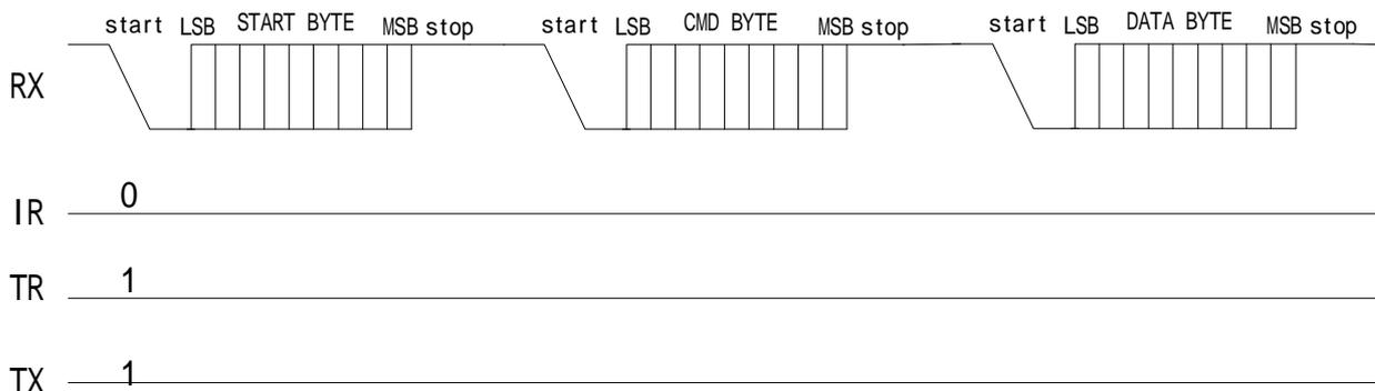
图 10.4.1 UART 主接口转义模式写操作时序
