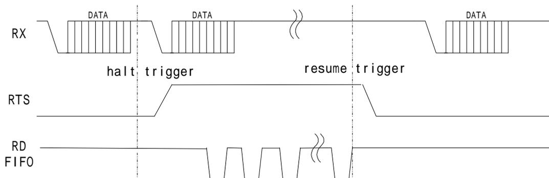
图 13.3.3.2 硬件流量操作时序图
