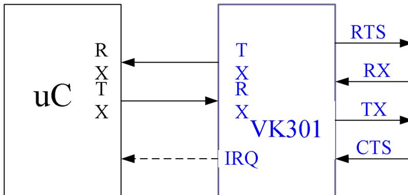
图 10.1 UART 接口与主机连接图
