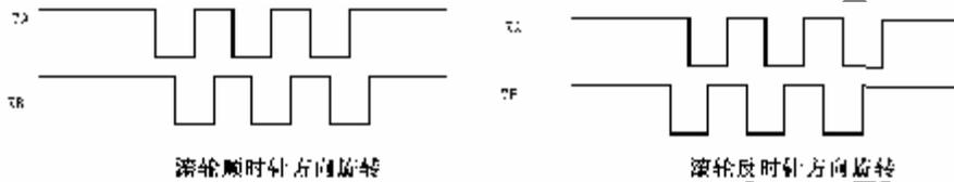
图 3: 触摸滚轮输出时序图
