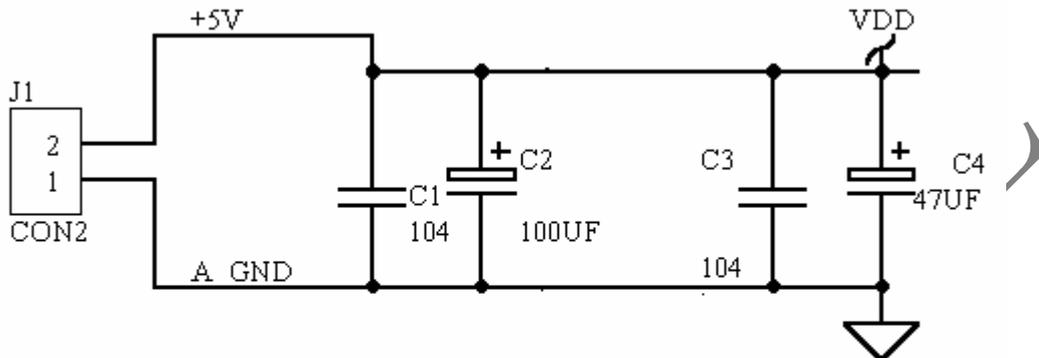
电路的模拟和数字部分的电源和地请分开用星型接法连接
