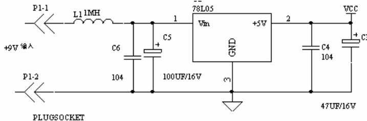
图 7:电源稳压电路
