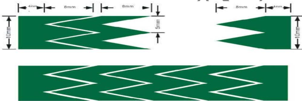
图 11:触摸滑条的几何图形和尺寸
