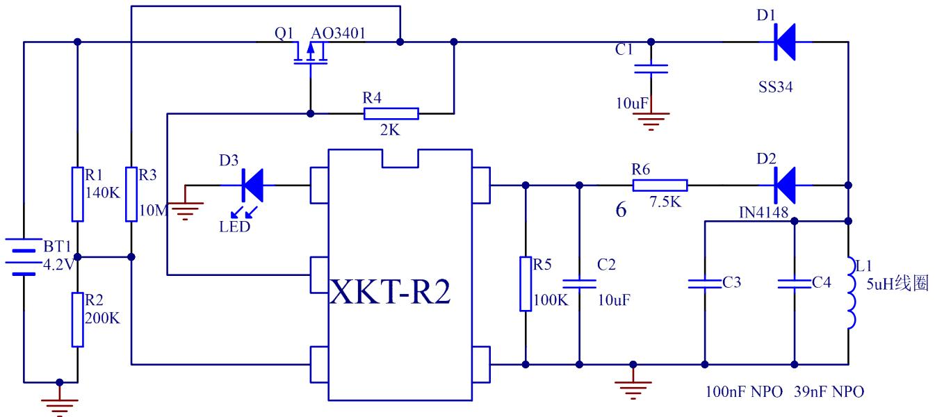
接收充电池电路的设计要求 (XKT-R2)：XKT-R2 是直接对电池等容性负载充电的，通过输出电压判断，输出到设定电压输出断电。适用于 4.2V 及以上电压的储能设备充电。后端直接接电池，若要加充电管理芯片在后端，那么，调整 XKT-R2 芯片的 R3，减小阻值可以加大可充电的回差电压，避免充电管理先关断引起电池电压下跌而导致 XKT-R2 会反复开关。电路中 D3 LED 灯为充电指示灯，充电时灯亮，充饱后灭，**D3LED 若不使用，不可以直接去掉**，需要替换为一个 3V 稳压二极管，否则电路无法工作。R1 为输出截止电压修改点，阻值加大，截止电压提高，以适用于不同电池。
