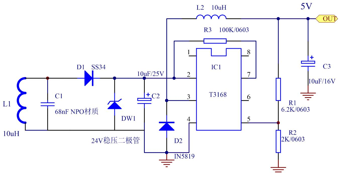
接收恒压输出电路的设计要求 (T3168) : T3168 芯片方案为恒压输出，输出特性是为用电部分提供一个恒压电源。输出电压可以通过 R1 进行调整，加大阻值提高电压（参考值：5V/6.2K, 12V/18K）。除去 L1 和 C1，其他器件可以根据输出电流的大小来调整封装大小，C2 和 C3 为滤波电容，为了稳定性，封装尺寸不可低于 0805。
