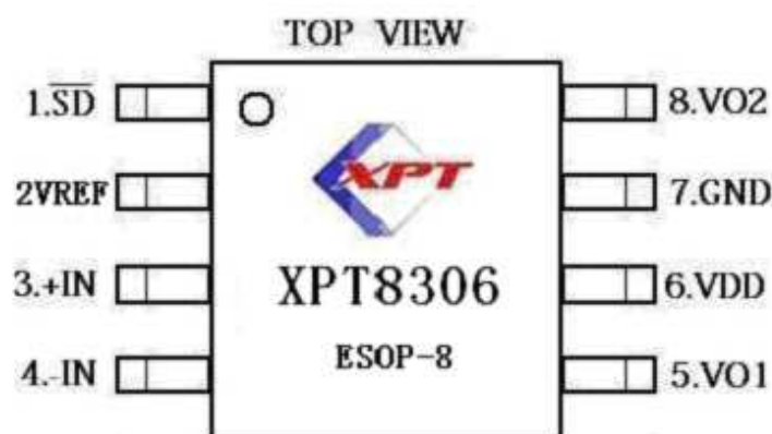
图为 XPT8306 ESOP8 封装的管脚分布图。
