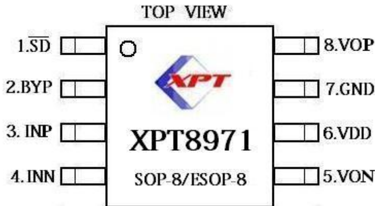
图 1 XPT8971 MSOP8、ESOP、SOP封装的管脚分布图。
