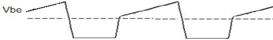
图 6: Vbe 驱动电压波形
