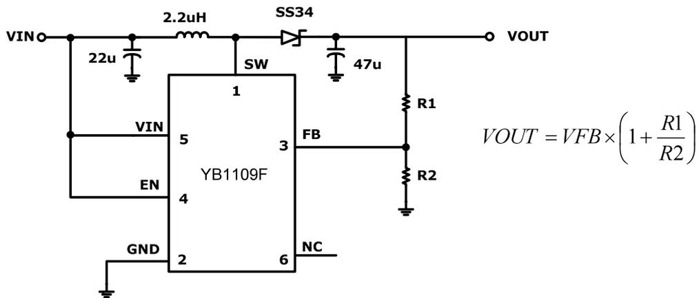
1.2A 超小型升压 DC/DC 电压调整器
