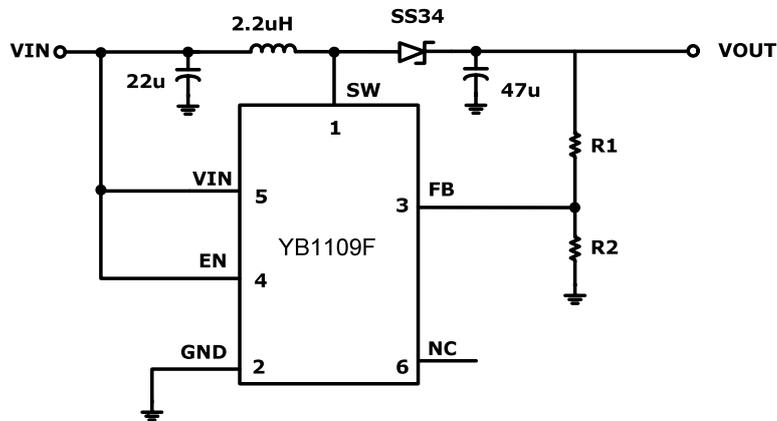
通过 FB 的外部电阻分压，输出电压值可根据以下公式计算：
