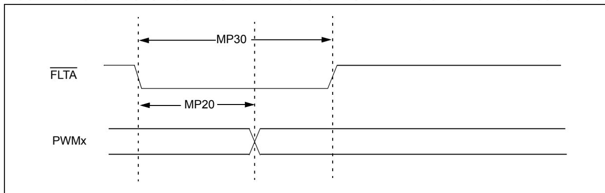
**FIGURE 24-11: MOTOR CONTROL PWM MODULE TIMING CHARACTERISTICS**
