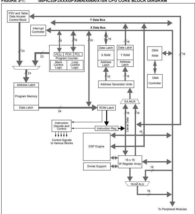
FIGURE 3-1: dsPIC33FJXXXGPX06A/X08A/X10A CPU CORE BLOCK DIAGRAM
