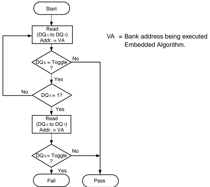
Note: DQ<sub>6</sub> is rechecked even if DQ<sub>5</sub> = "1" because DQ<sub>6</sub> may stop toggling at the same time as DQ<sub>5</sub> changing to "1" .
