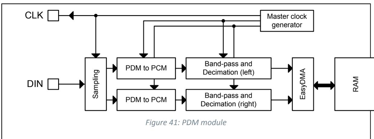
Figure 41: PDM module
