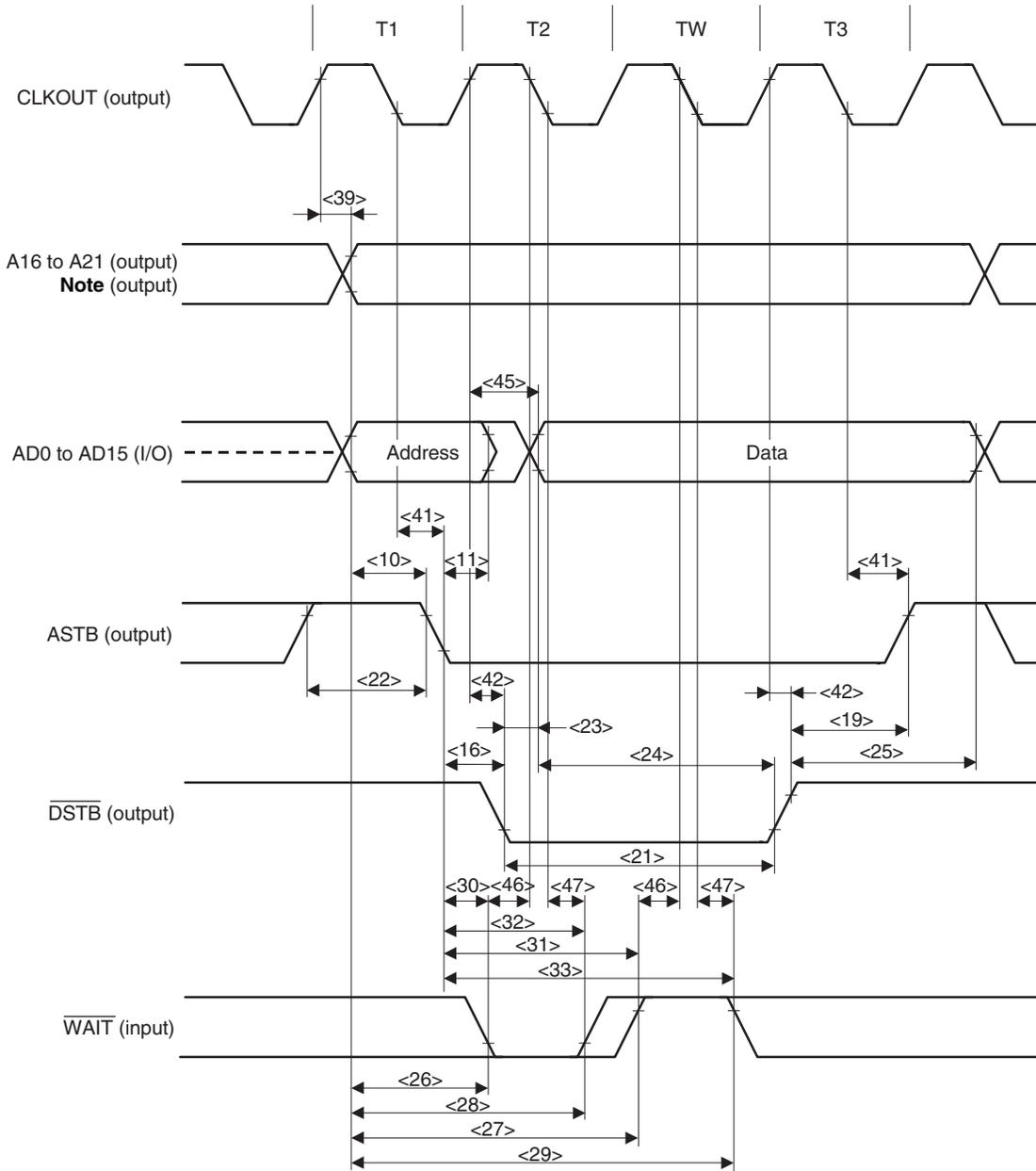
**Note**  $\overline{R/W}$ ,  $\overline{UBEN}$ ,  $\overline{LBEN}$
