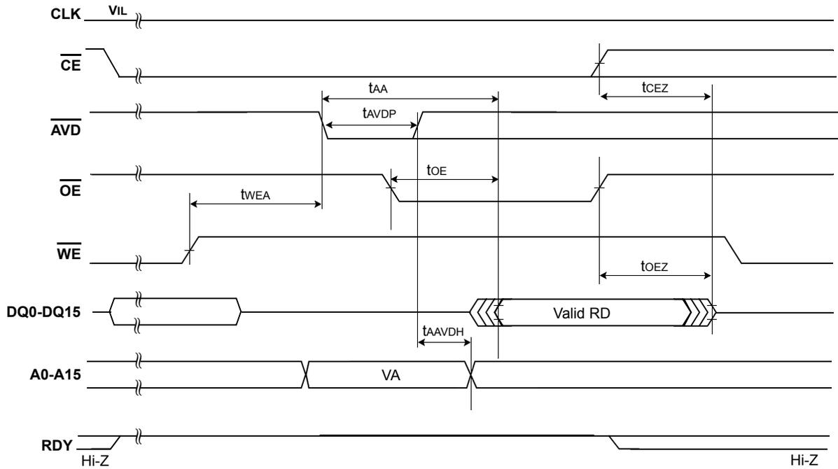
Figure 31. Asynchronous Read Mode( $\overline{\text{AVD}}$  toggling)
