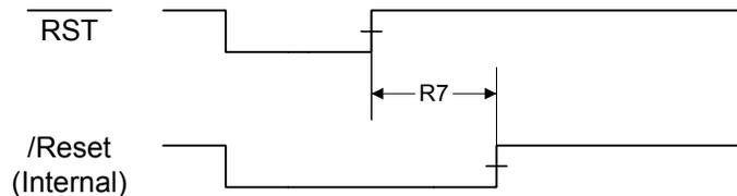
Figure 19-10. Power-On Reset Timing
