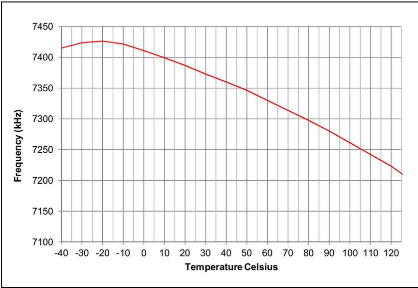
**FIGURE 27-10: TYPICAL LPRC FREQUENCY @ V<sub>DD</sub> = 3.3V**
